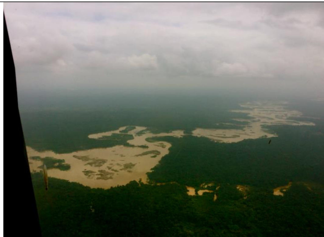
Folio 2129 del Cuaderno de pruebas Núm. 5. Inundación de bosque nativo por acción de las dragas en el río Atrato. También se pueden apreciar montañas o “islas” de arena en el río que son consecuencia de la explotación minera ilegal. Enero 29 de 2016.
